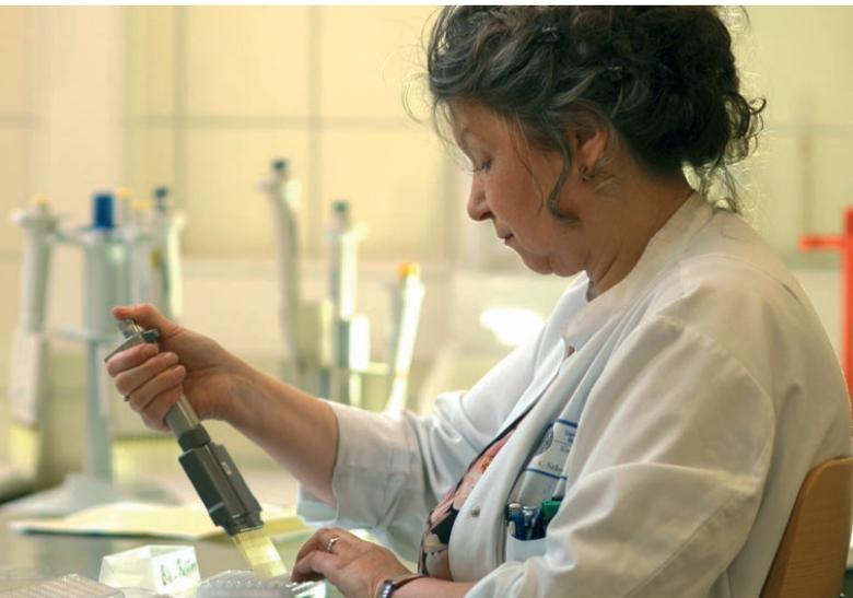
Farbstoff gebildet wird. Die Konzentration wird photometrisch aus der optischen Dichte errechnet.
