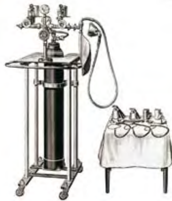
Abb. 1.11: Roth-Dräger Narkosegerät von 1903 mit Äthertropfvorrichtung.
