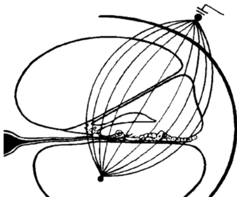
Abb. 3: Verlauf der elektrischen Feldlinien zwischen einer Elektrode innerhalb der Hörschnecke und einer externen Referenzelektrode (schematisch). Die elektrischen Feldlinien durchqueren die flüssigkeitsgefüllten Hohlräume sowie die Rudimente des Corti-Organ und die Endungen der Hörnervenfasern (nach W.F. House, 1975).
