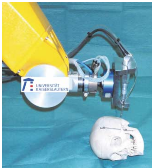
Abb. 1 ◀ Fräser in Aluminiumhalterung vor der Kraftmessdose an den 6-achsigen Knickarmroboter montiert
