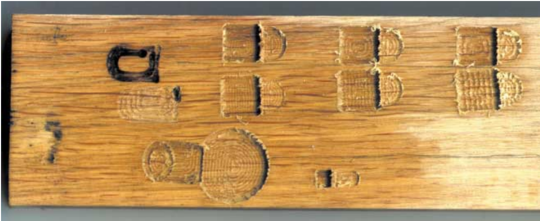
Abb.4 ▲ Zu betrachten sind die 6 Lager rechts oben. Diese sind jeweils mit einem Rosenbohrer mit Durchmesser 4,5 mm ausgefräst worden (Radius r_1=2,25 mm, man hat festgelegt: r_2=2 mm). Die obere Reihe in Horizontalfräsung und die untere Reihe in Vertikalfräse. Von links nach rechts haben wir den Bahnabstand r_3 und das vertikale Offset r_4 variiert. Linke Spalte: Bahnabstand r_3=1,125 mm ( =0,5 r_1 ), vertikales Offset r_4=1,06 mm; mittlere Spalte: Bahnabstand r_3=1,575 mm ( =0,7 r_1 ), vertikales Offset r_4=1,26 mm; rechte Spalte: Bahnabstand r_3=2,25 mm ( =1,0 r_1 ), vertikales Offset r_4=1,50 mm. Es zeigt sich eine deutliche Zunahme der Rillenhöhe bei steigendem Bahnabstand
