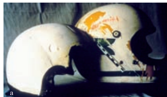
Abb. 5 a) Integralhelm und dessen Schutzpolsterung (links) nach energiereichem Anprall gegen alten Schutzplankenpfosten. b) Pfostenprofile von Schutzplanken: IP 100 und IPE 120 (Doppel-T-Profil); am oberen Pfosten: Anpralldämpfer der Fa. SPIG; im Vordergrund: Pfosten mit Sigma-Profil; Quelle: IRVM, TBU, Heidelberg
