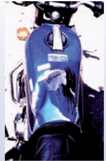
Abb. 8 Tankverformung infolge Körperanpralles des Motorradfahrers im Genitalbereich mit schweren Verletzungsfolgen. Quelle: IRVM, TBU, Heidelberg
