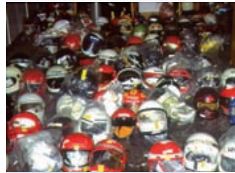
Abb. 14 Aussortierte unfallbelastete Schutzhelme der Motorrad-sicherheitsforschung Heidelberg nach Abschluß der Helmuntersuchungen und traumatomechanischen Analysen.
