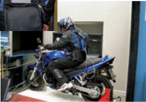
Abb. 7 Windkanalmessungen zur Korrelierung individueller Meßdaten von Testfahrern mit aerodynamischen aeroakustischen Daten an Meßpuppen. Quelle: IRVM, TBU, Heidelberg
