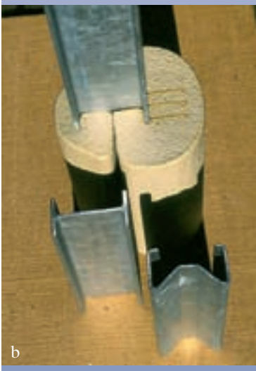
Abb. 5 a) Integralhelm und dessen Schutzpolsterung (links) nach energiereichem Anprall gegen alten Schutzplankenpfosten. b) Pfostenprofile von Schutzplanken: IP 100 und IPE 120 (Doppel-T-Profil); am oberen Pfosten: Anpralldämpfer der Fa. SPIG; im Vordergrund: Pfosten mit Sigma-Profil; Quelle: IRVM, TBU, Heidelberg
