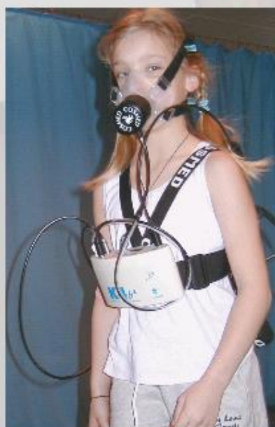
Ausrüstung für die O 2 -Verbrauchsmessung
