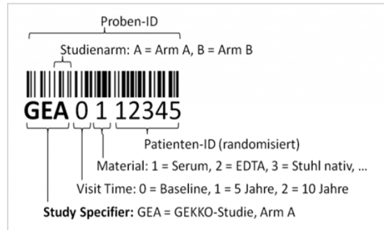
Bild 1: Beispielhafte Darstellung und Bedeutung eines Barcodes
